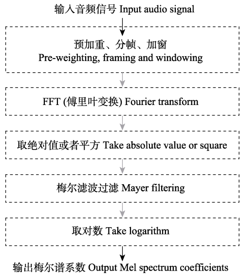
图2 梅尔谱系数提取流程图 Fig. 2 Mel spectrum coefficient extraction flow chart
